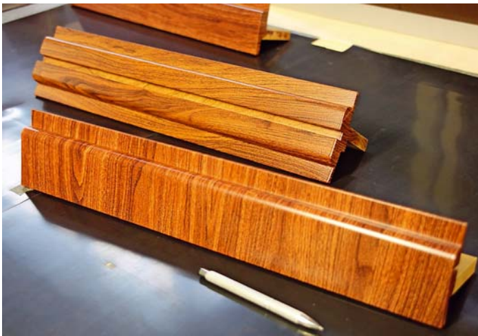
Noch im Experimentierstadium ist derzeit der Wassertransferdruck, mit dem Metalle mit hochwertigen, fest haftenden Dekoren z. B. im Holzlook veredelt werden können. Bild: Klaus Vollrath
